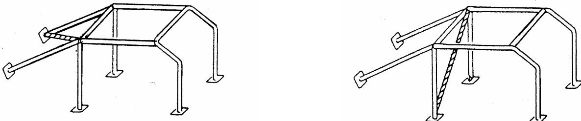
Die Fläche der übrigen Befestigungspunkte muss dem betreffenden Zertifikat bzw. dem Homologationsblatt entsprechen. Darüber hinaus ist die Fläche dieser Punkte freigestellt, wobei an diesen Punkten die Rohre auch direkt mit der Karosserie verschweißt werden dürfen.
